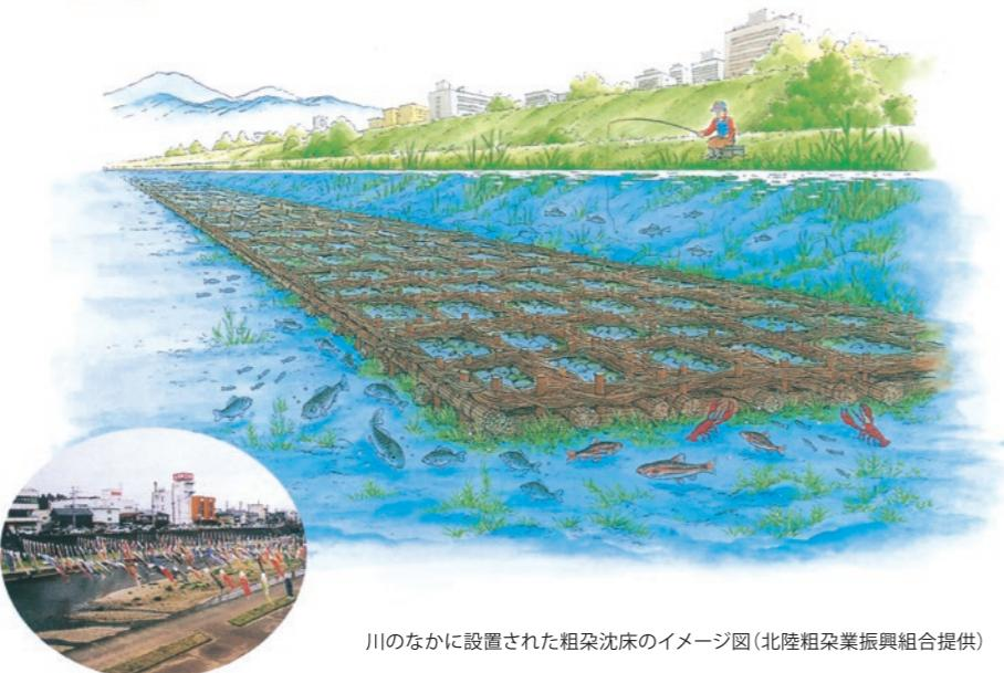
川のなかに設置された粗朶沈床のイメージ図(北陸粗朶業振興組合提供)
