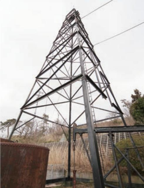
明治30年から昭和60年まで、90年間働き続けた掘削機。日本で初めて成功した綱式掘削機と同型である。(写真上)
