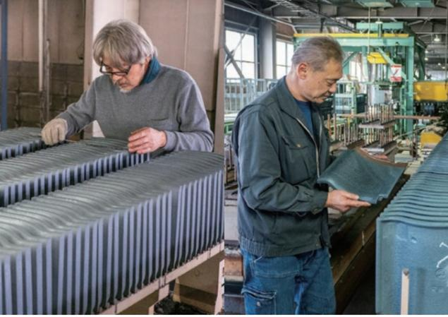
窯から出て間もない熱い瓦の寸法を確認したり、冷却後の瓦の反り具合など、梱包前に品質の最終チェックをする熟練工たち。
