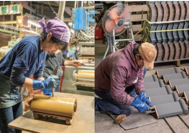
『役瓦』を作る工場棟では手馴れた職人が、伝統的な工法で特殊な形状の瓦をひとつひとつ手づくりする。
